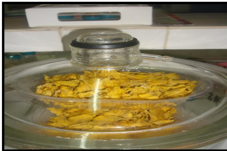
Foto II- 25 Enfriamiento de la muestra seca de zapallo en un desecador
