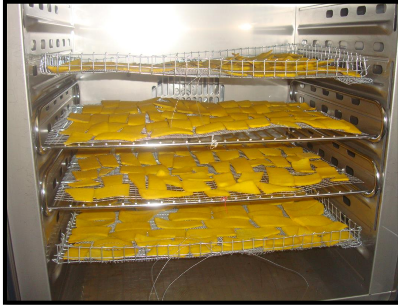
Foto II- 21 Bandejas con muestra de zapallo dentro del secador
