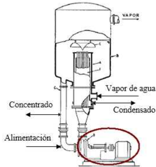
Figura 1-7 EVAPORADOR DE CIRCULACIÓN FORZADA
