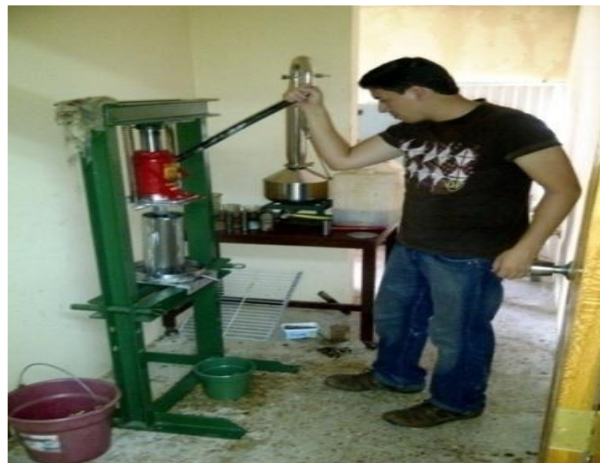
Figura 1-2: Proceso de extracción mediante prensado hidráulico
