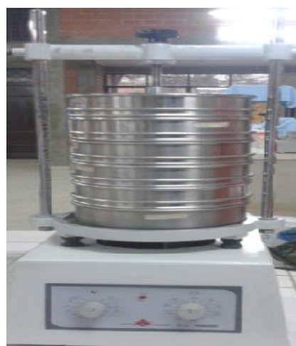
Figura 2-6: Tamizado de las semillas de ricino
