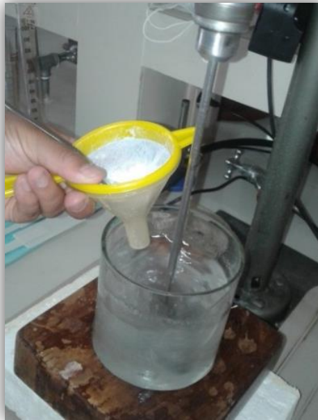
Figura II – 14: TAMIZADO DE CARBOPOL
