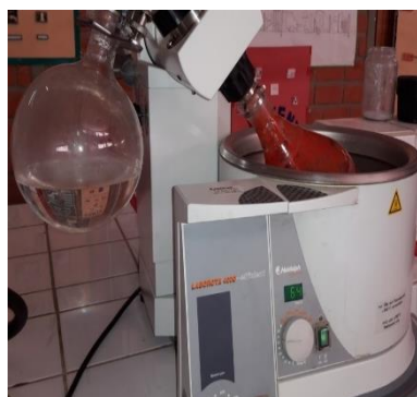
Figura 3.10 Concentrado en rotavapor
