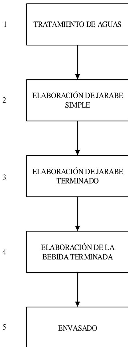
1.- Se tiene un sistema de tratamiento de múltiple barrera, la cual consta de un tanque reactor, en donde se adiciona hipoclorito de sodio, hidróxido de calcio y cloruro férrico, dando lugar a un proceso fisicoquímico de coagulación y floculación, posteriormente el agua pasa a un filtro de arena, luego a un filtro de carbón y por ultimo a un filtro pulidor. Punto en el cual ya se considera una agua tratada que cumple con todas las especificaciones de EMBOL Tarija
