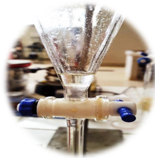
Foto 2. 13. Separación de aceite esencial y agua
