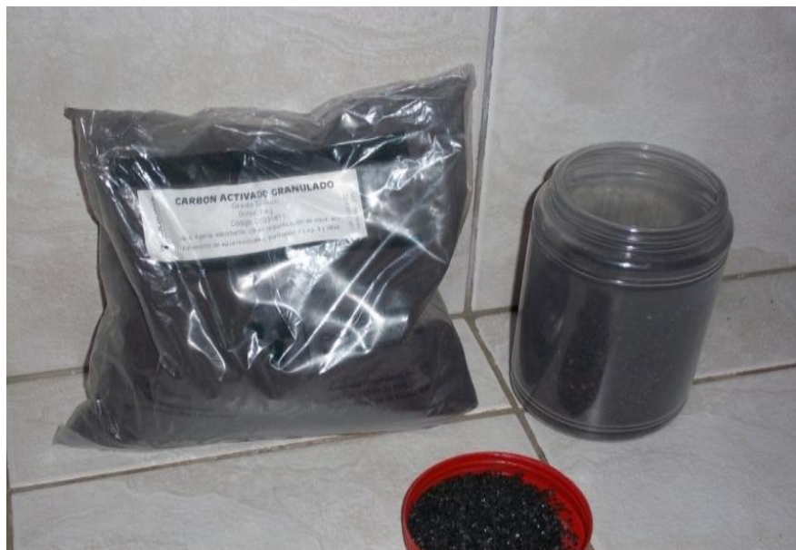
Fig 2-17 (carbón activado para clarificar y desodorizar)
