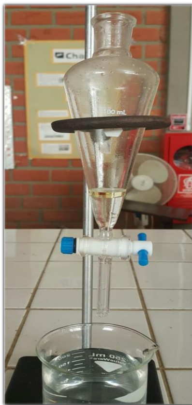
Figura 3-11: Decantación en una ampolla de separación
