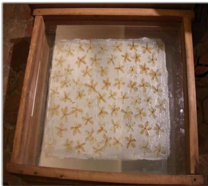
Figura 2-12: Método de disolución en grasa (enfleurage)
