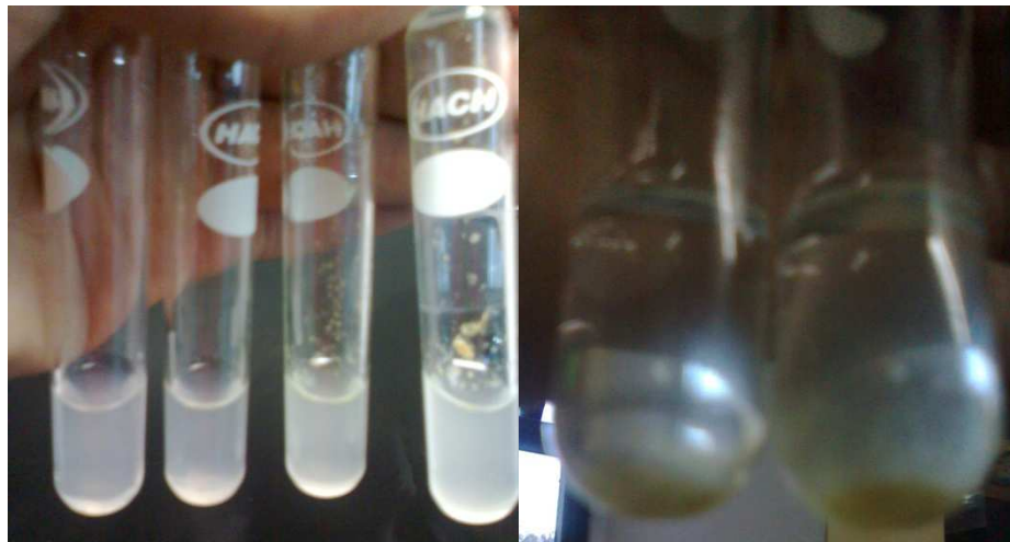
Figura 2-19 Muestras totalmente decoloradas después del ensayo de índice de oxidación
