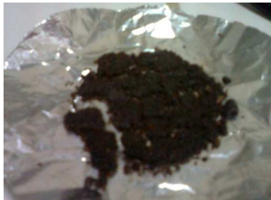
Figura 2-9 Muestra fundida en el ensayo de determinación de la humedad.
