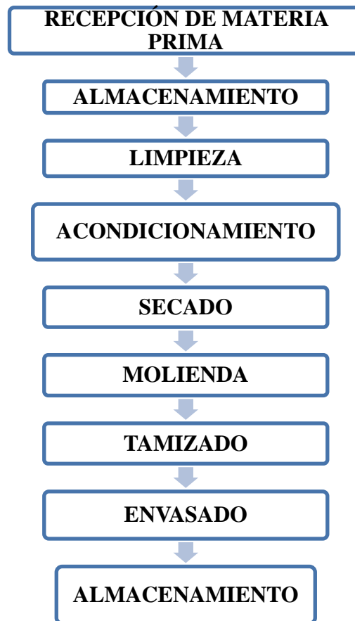
Diagrama I-1 Proceso tecnológico de obtención de harina
