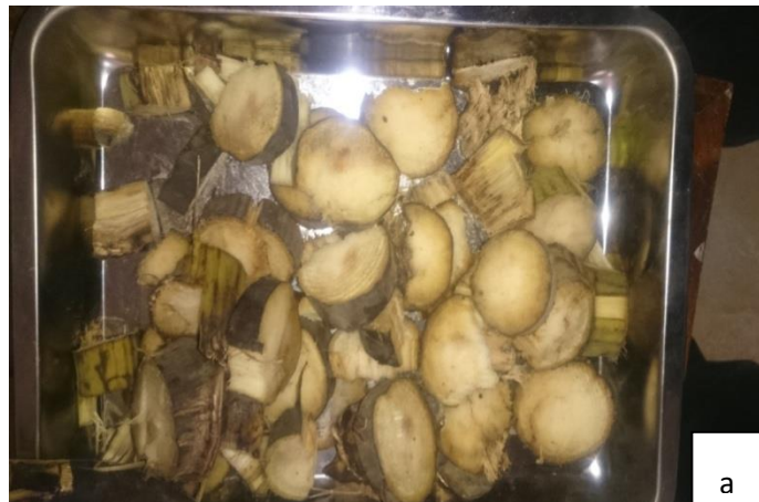
Figura 3-4 Reducción de tamaño del material lignocelulósico: a) tallo floral, b) raquis, c) pseudotallo, d) hojas
