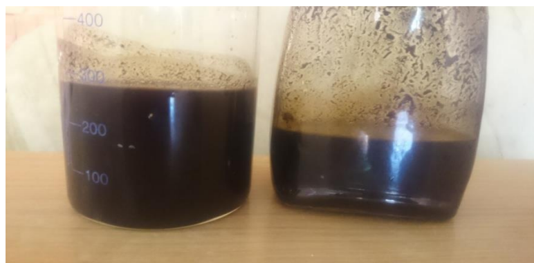
Figura 3-6 Sustrato después de la hidrólisis ácida.
