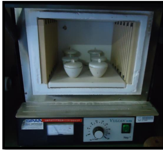
Figura 3-4: Calcinación en crisoles dentro de la mufla
