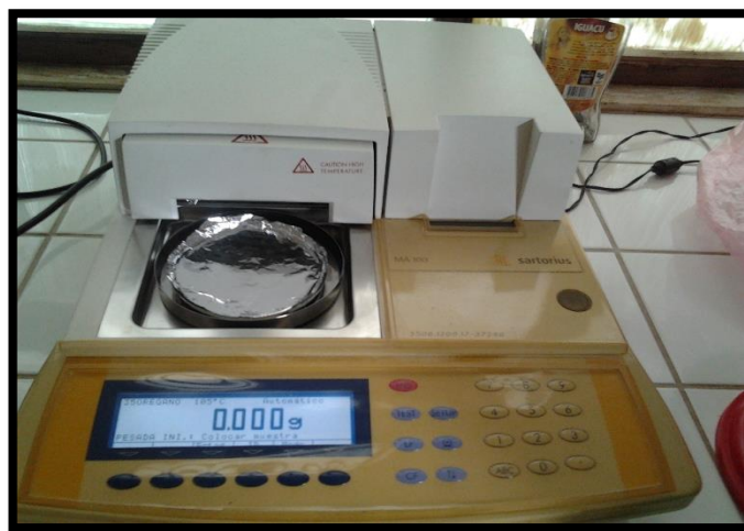
Figura 3-2: Analizador infrarrojo SARTORIUS MA 100
