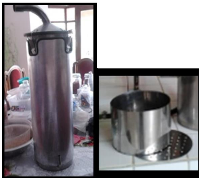
Figura 3-16: Cámara de extracción modificada y canastillos de acero inoxidable
