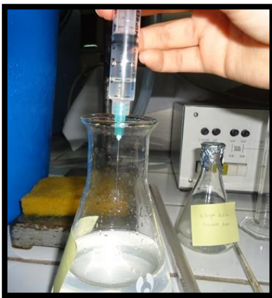
Figura 3-19: Medición del volumen de aceite esencial para el cálculo del rendimiento
