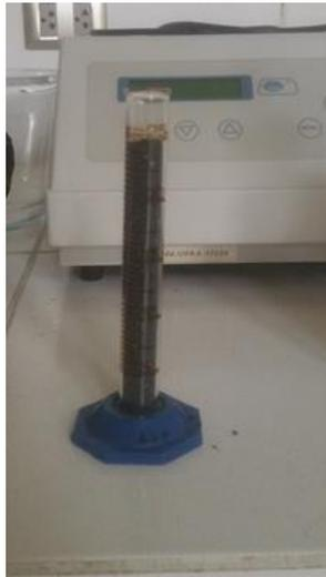
Volumen de agua medido en la probeta 2 = 50ml
