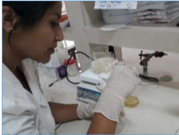
Foto 2.17: Filtración y Solubilización de la muestra
