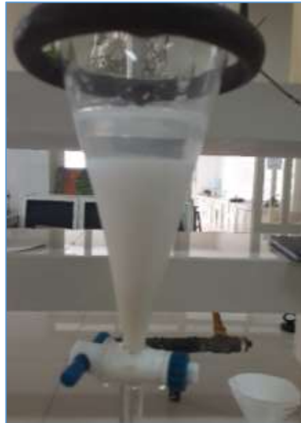
Foto 2.16. Proceso de lavado en la ampolla de decantación
