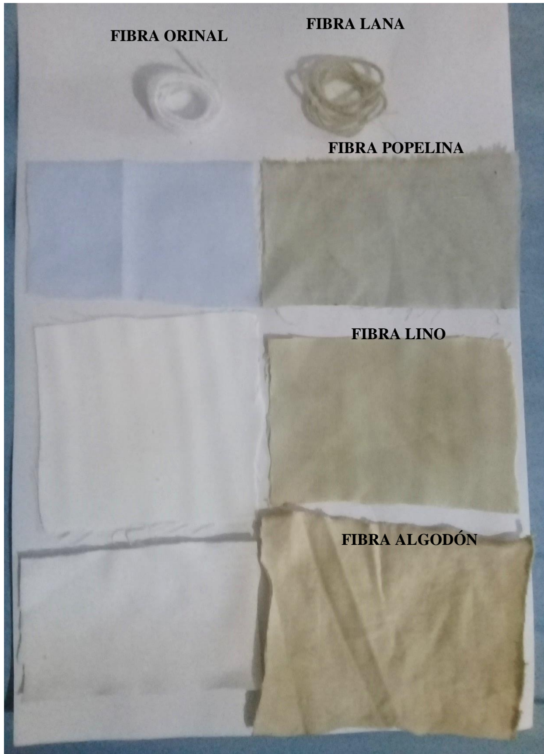
Figuras 18. Primera prueba de tinción con sulfato de ferroso con 100 ml de colorante al 5 % de concentración
