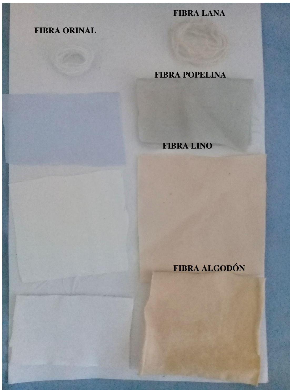
Figuras 15. Primera prueba de tinción con sulfato de sodio con 100 ml de colorante al 5 % de concentración
