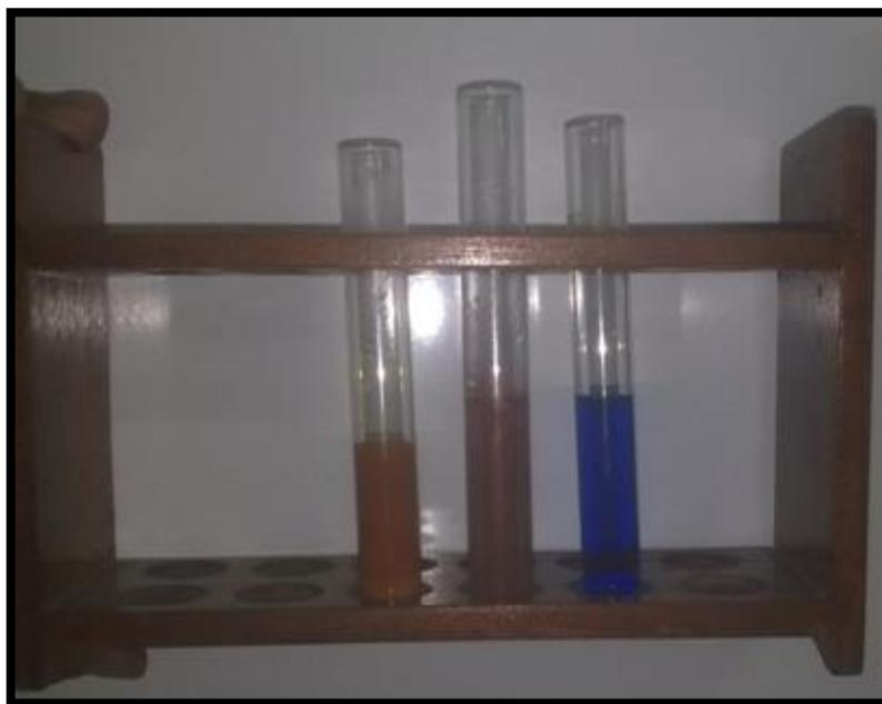
La figura 3-5 muestra los resultados obtenidos en la prueba de Fehling. La solución de color azul es el licor de Fehling añadido a una muestra de agua destilada, la
