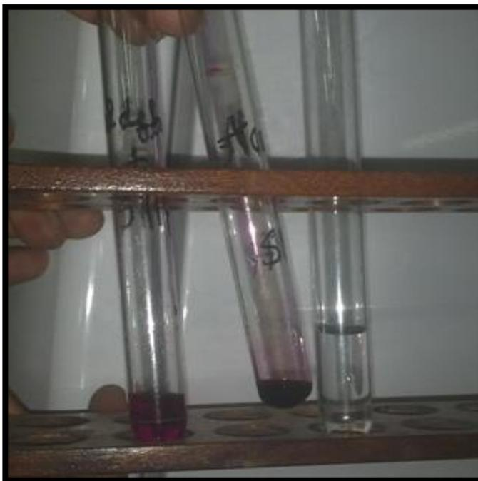
La figura 3-6 muestra los resultados obtenidos con la prueba de Schiff. La solución transparente es el resultado de añadir solución de Schiff al agua donde se demuestra que el agua no tiene aldehídos.
