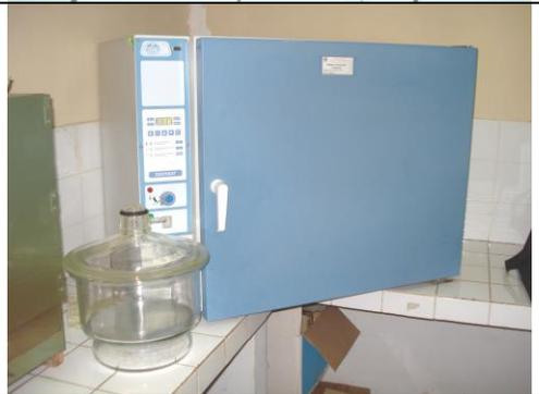
Extraer la cápsula de la estufa y depositarla en un desecador, hasta que esté fría. Posteriormente se pesa.
