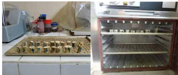
Luego de haber materializado la ruptura de la probeta en todos los ensayos de propiedades mecánicas practicados, de la parte más cercana a la falla o ruptura, se extrajo una galleta de 3 cm de ancho para verificar el contenido de humedad.
