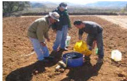
Fotografía que muestra el inicio de una prueba de infiltración
