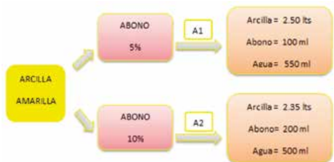
Figura 15. Revestimiento tipo "A"
