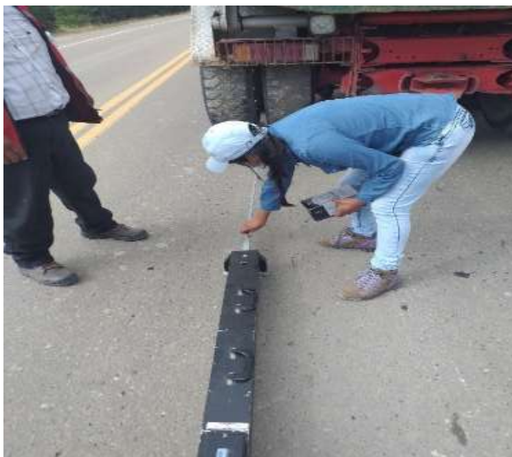
Figura 5. Ensayo de viga Bekelman.
