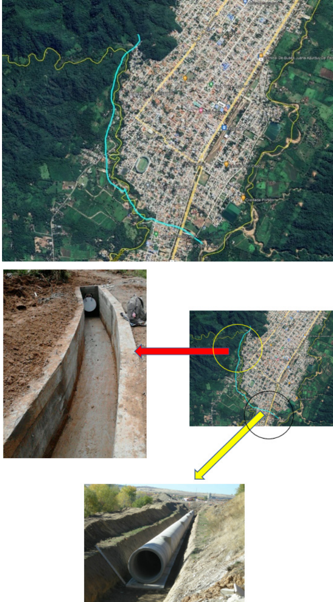
Figura 16. Trazado Propuesto para el Canal Perimetral (línea celeste)
