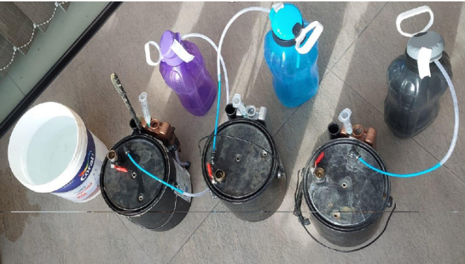
Fotografía 2. Bebedero de control y bebederos termo solares conectados a los depósitos de recolección de caudal.
