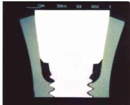
Figura 8. Vista en corte trasversal de un implante con el diseño friccional en "Cono Morse"
