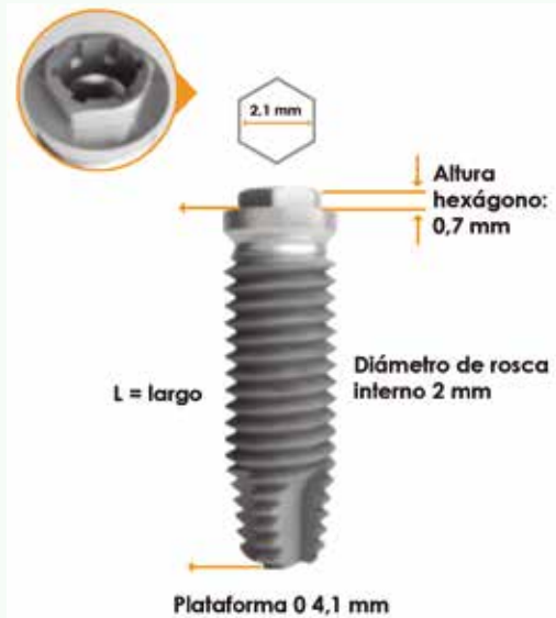
Figura 5. El esquema muestra la plataforma de un implante hexágono externo
