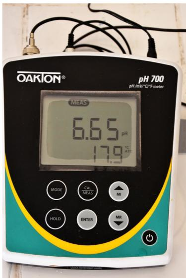
Imagen 4. Potenciómetro o pHmetro digital de mesa para Laboratorios de análisis clínicos
