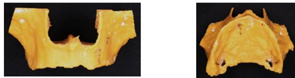
Fig. 9 y 10 Biomodelo construido con tecnología de Inyección aglutinante. Fuente: Propia
