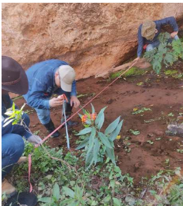
Figura 4. Medición de caudales y aforos respectivos en el punto de muestreo en la cuenca alta.
