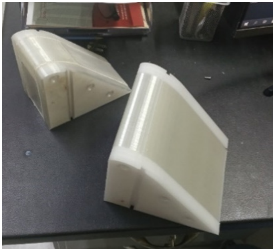
Vertedero tipo Creager de 10 cm de longitud
