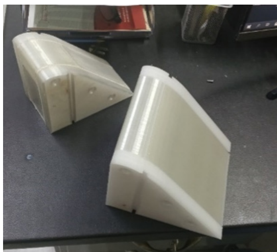
Vertedero tipo Creager de 10 cm de longitud
